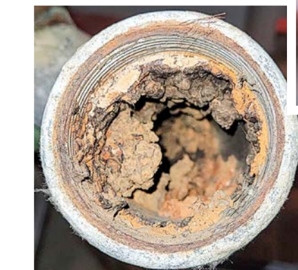
Bilden ovan visar ett igensatt kopparrör där den fria frontarean har krympt som gör att tryckfallet blir stort. Till vänster ett galvat stålrör med betydande invändiga kalkavlagringar.
