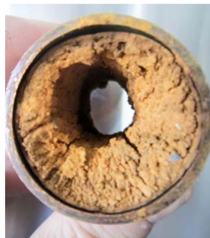
Bilden ovan visar ett igensatt kopparrör där den fria frontarean har krympt som gör att tryckfallet blir stort. Till vänster ett galvat stålrör med betydande invändiga kalkavlagringar.
